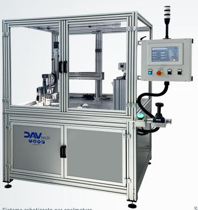
Sistema robotizzato per spalmatura vernice protettiva su componente.
