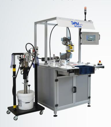
Banco robotizzato per dosatura grasso damping su componenti meccanici.
