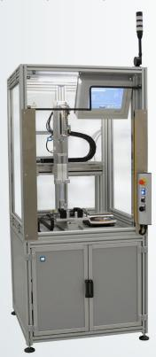
Cella robotizzata per dosatura pasta termo-conduttiva su componenti automotive.
